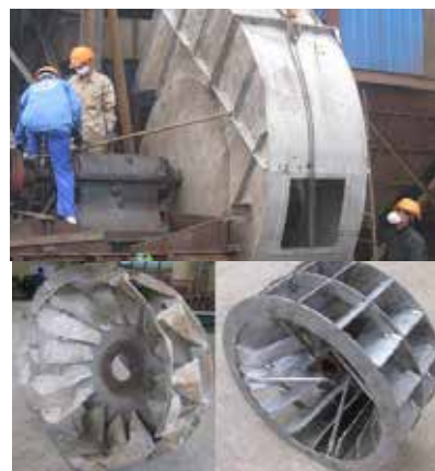
Hình ảnh một guồng cánh quạt ly tâm được TOMECO phục hồi nhanh chóng sau khi bị hư hỏng hoàn toàn
